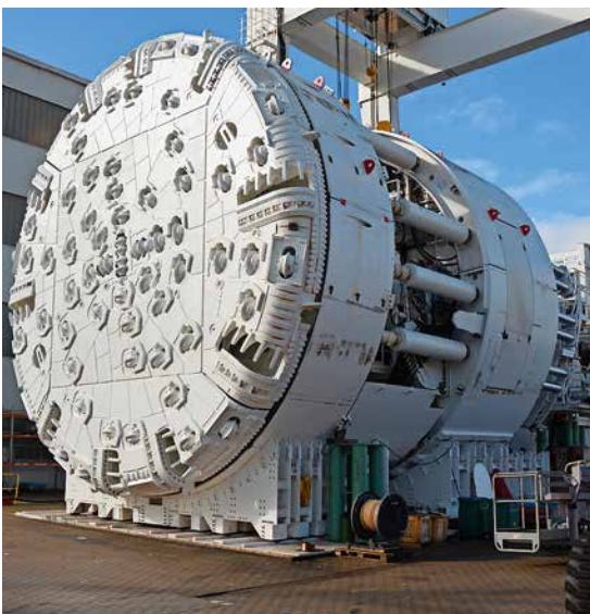
Herrenknecht fertigt Tunnelbohrmaschinen (TBM) für alle Geologien, von kleinen Durchmessern bis zu 19 Metern. TBM sind quasi eine Fabrik unter Tage: Sie bohren sich durch den Untergrund, fördern den Abraum ab und erstellen gleichzeitig aus Stahlbetonsegmenten die fertige Tunnelröhre.
