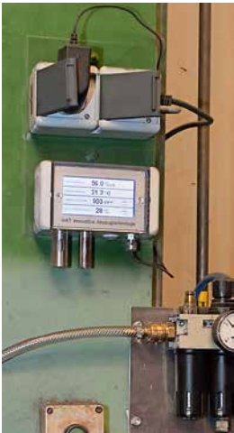
Das Display am Arbeitsplatz zeigt die Werte für Luftfeuchte, Temperatur, CO 2 -Gehalt und Luftqualität und signalisiert mit einem Smiley, ob alles in Ordnung ist oder nicht.
